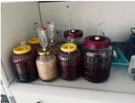
Joonis 13 Õlilukuga varustatud kääritusnõud Käärimisprotsessi lõppedes pressiti kääritatud mahlad kruvipressiga ja pressjäägid külmuivatati.
